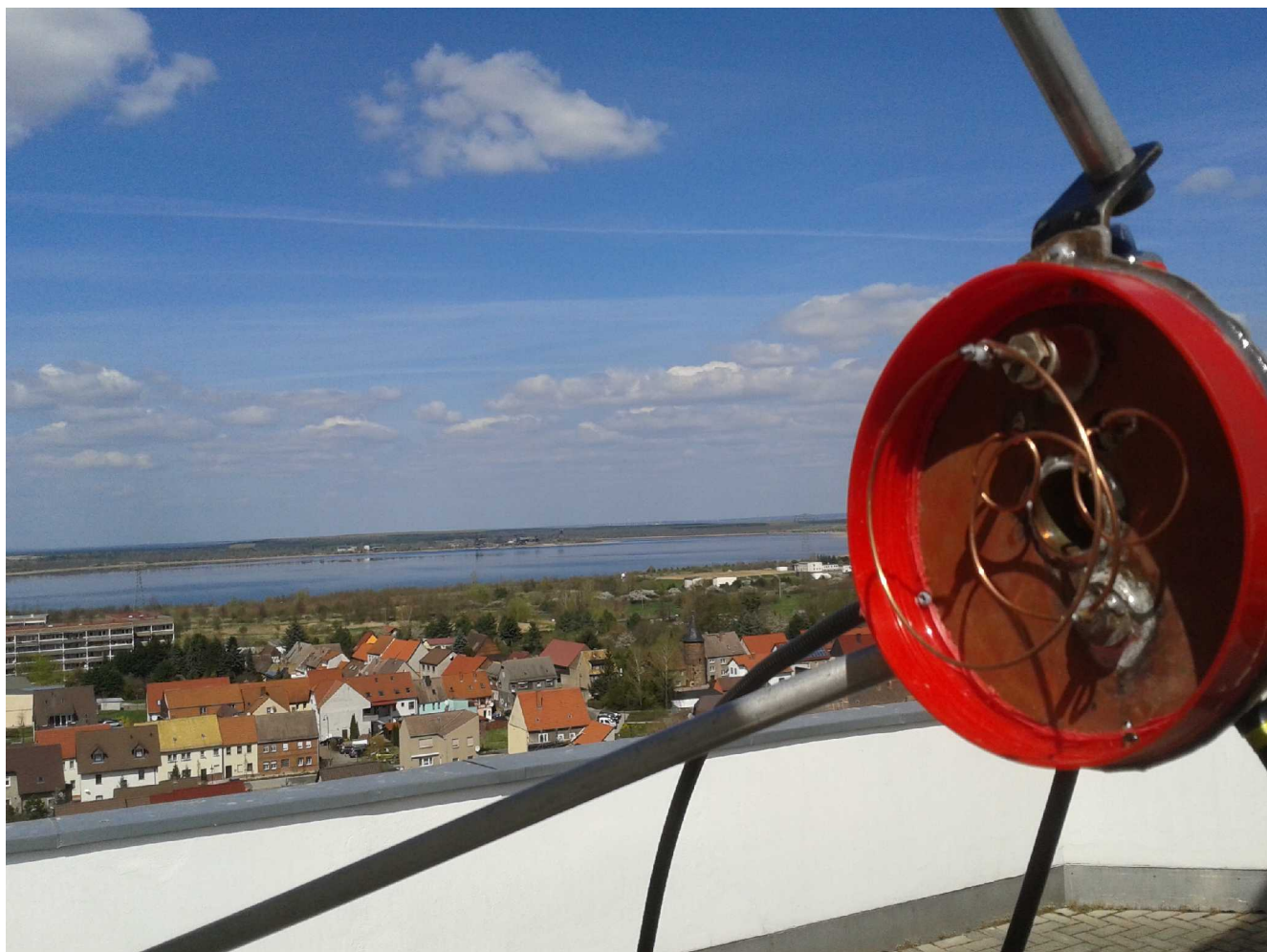
Micha, DL1HSF: sehr mäßiges Stationsangebot trotz TOP Wetter. Ich habe einen neuen 5-Banderreger mit Erfolg getestet. Der Schiel - Effekt auf 9cm und 6cm auf Grund der Anordnung der Ring-Dipole konnte erheblich verbessert werden. DK65DARC ( DK0NA) von 23 - 3cm war die Belohnung für den Aufstieg zum Wasserturm. Im Hintergrund die Halbinsel Ferropolis mit der Konzertarena. www.ferropolis.de
