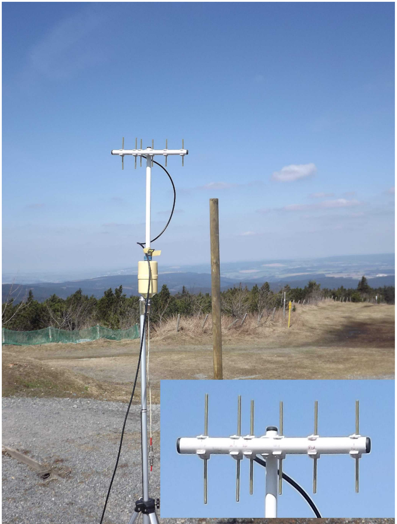
DL2HSC-Stn. auf dem Fichtelberg, JO60LK, mit Eigenbau - Yagi für den Bergwettbewerb
