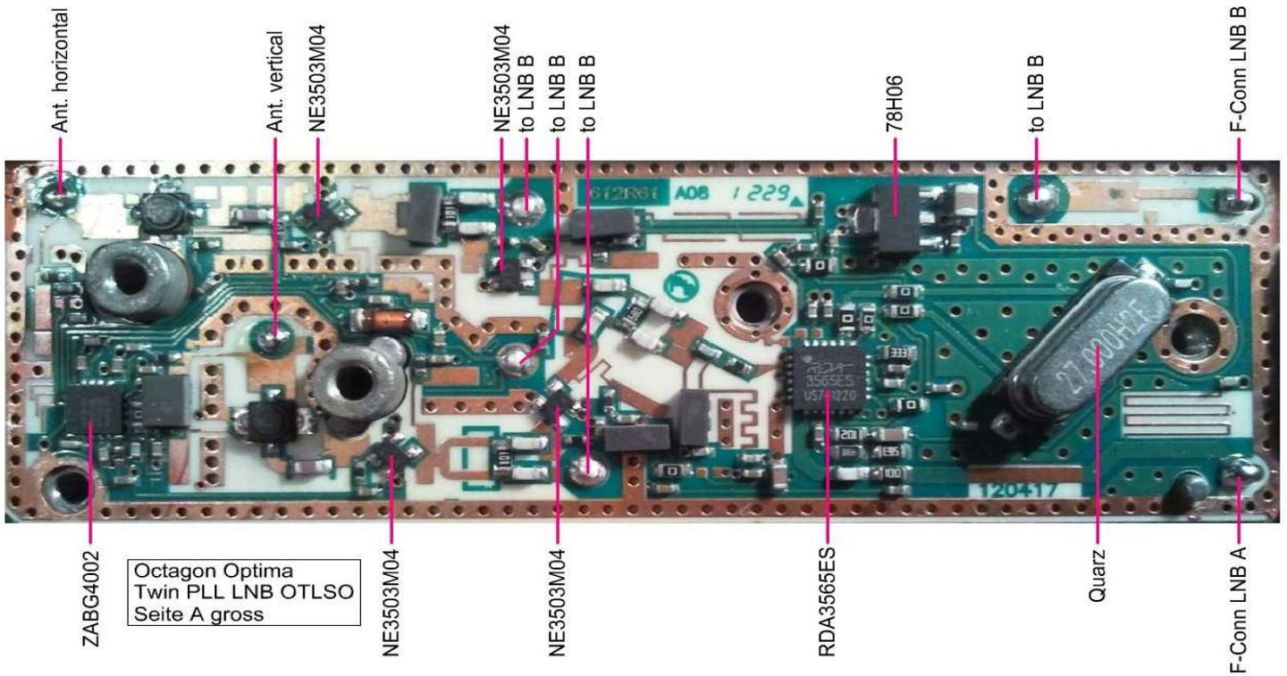
*Umbau des Octagon LNB mit 27MHZ TCXO für ES Hailsat: Austausch des Quarzes durch den TCXO direkt im LNB. zusätzlich noch ein 3.3V Spannungsregler und eventuell eine kleine SMD Platine mit Filtern:
