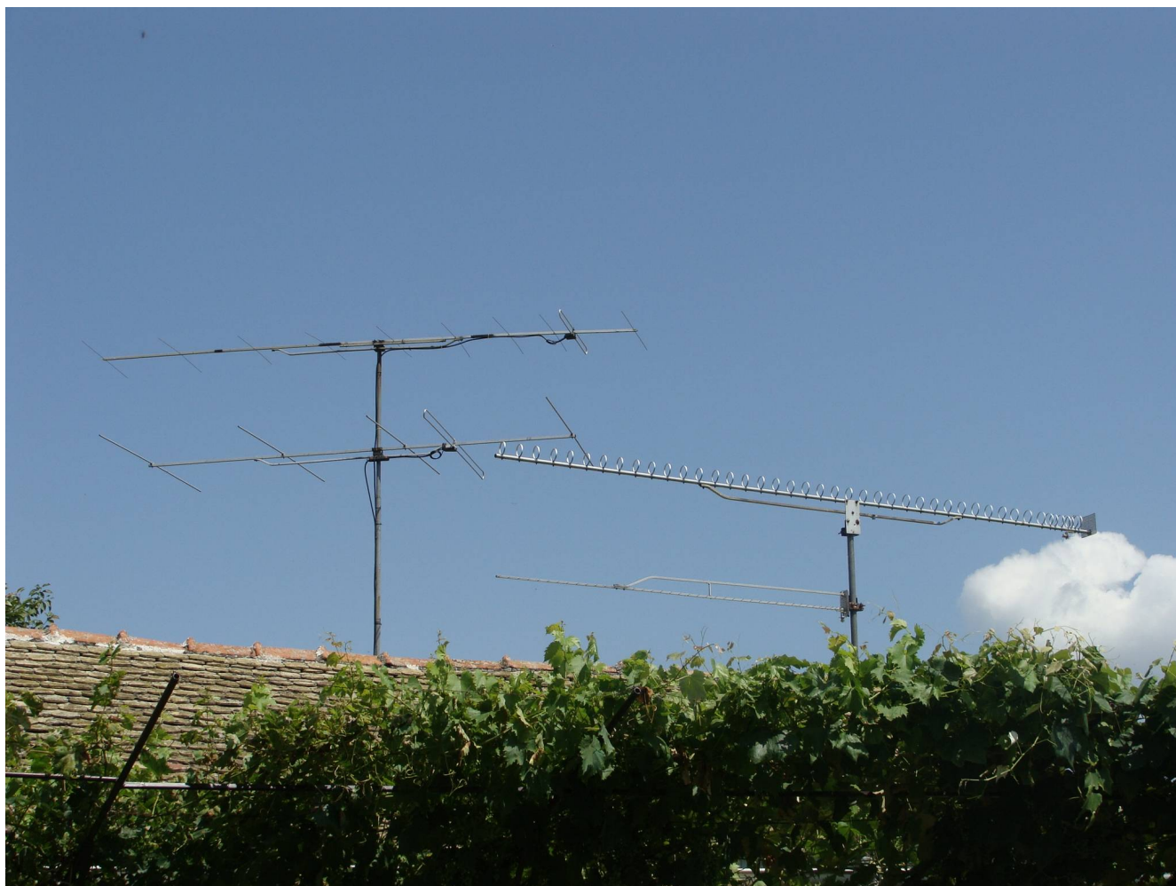
50 Elemente-Loop-Yagi für 23cm im QTH von Zlatko 9A2SB
