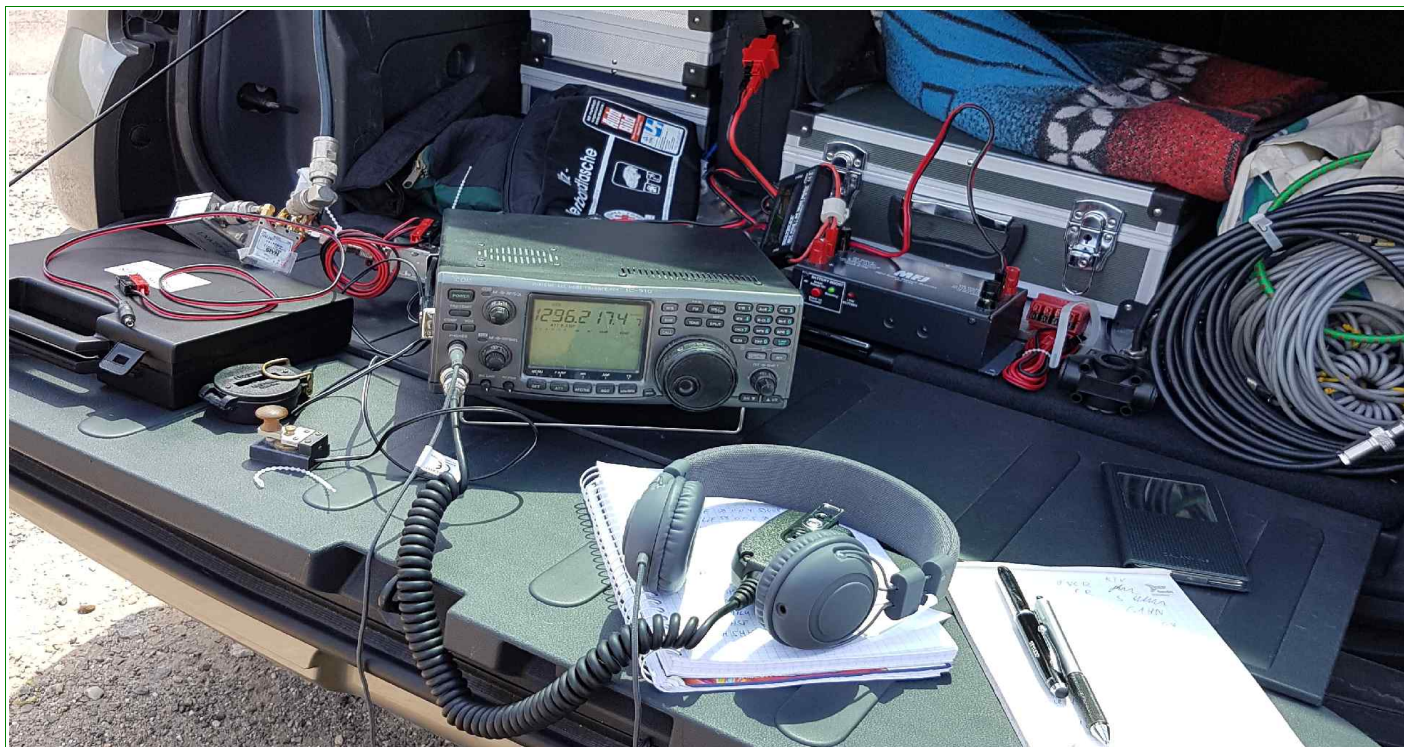
Spannungsbooster von MFJ für 13,8V ... ein wichtiges Gerät bei Akkubetrieb.
