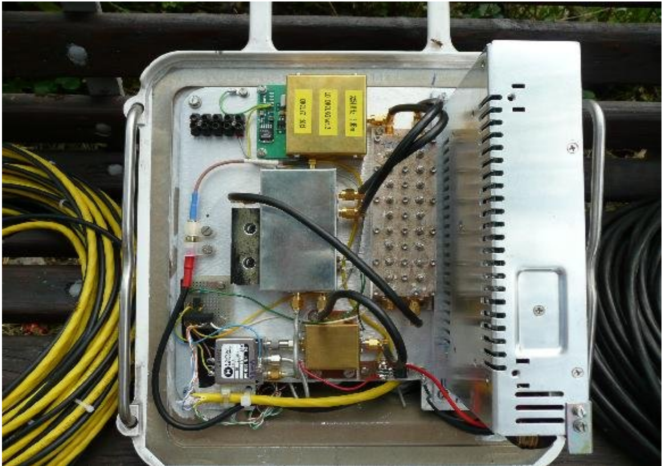
Neuer 9cm-Transverter von Mirek, OK2UYZ
