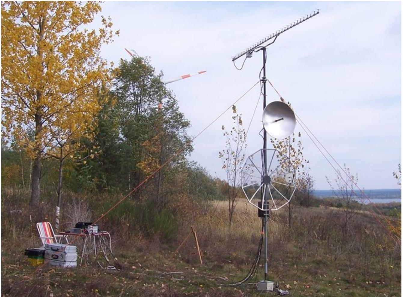
Antennen und Wind war bei mir immer ein Problem. Ab 23cm ging oft gar nichts mehr. Meine Lösung besteht darin, dass ich den Mast immer auf ein Drehgerät stelle. Ich benutze dazu die Hälfte des Innenlebens eines Drehgerätes, dass zu DDR-Zeiten für Videoüberwachungskameras im Außenbereich benutzt wurde. Ist sehr stabil, absolut ohne Spiel und arbeitet mit 12V, also auch für Akkubetrieb geeignet. Es dreht schnell, läuft aber auch mit weniger als 12V langsamer. Spiel hat
