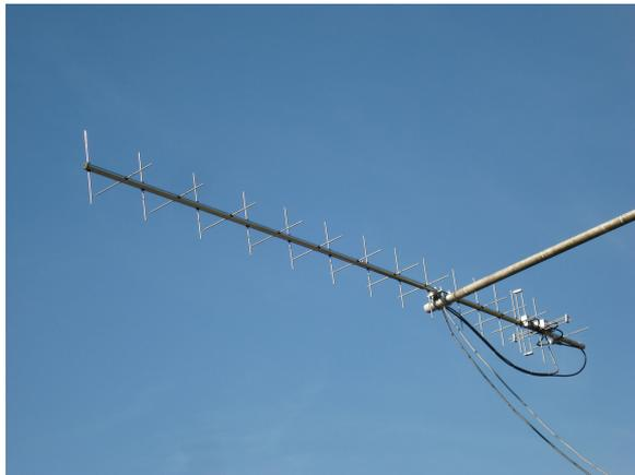
Bild2: M<sup>2</sup> 34CP30 für 70cm bei DL0IKT
