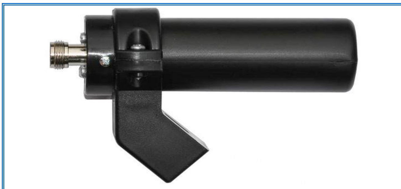
Feed für Standard (offset) Spiegel mit f/d 0.5–0.8, QRG: 5.1-5.9 GHz, Gewinn: 10.2 dBi ....siehe https://www.antennas-amplifiers.com
