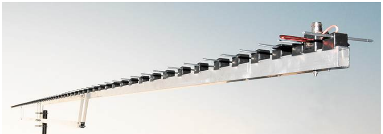
70-Element-Antenne für EME 6m lang, 23,2dBi ....siehe https://www.antennas-amplifiers.com
