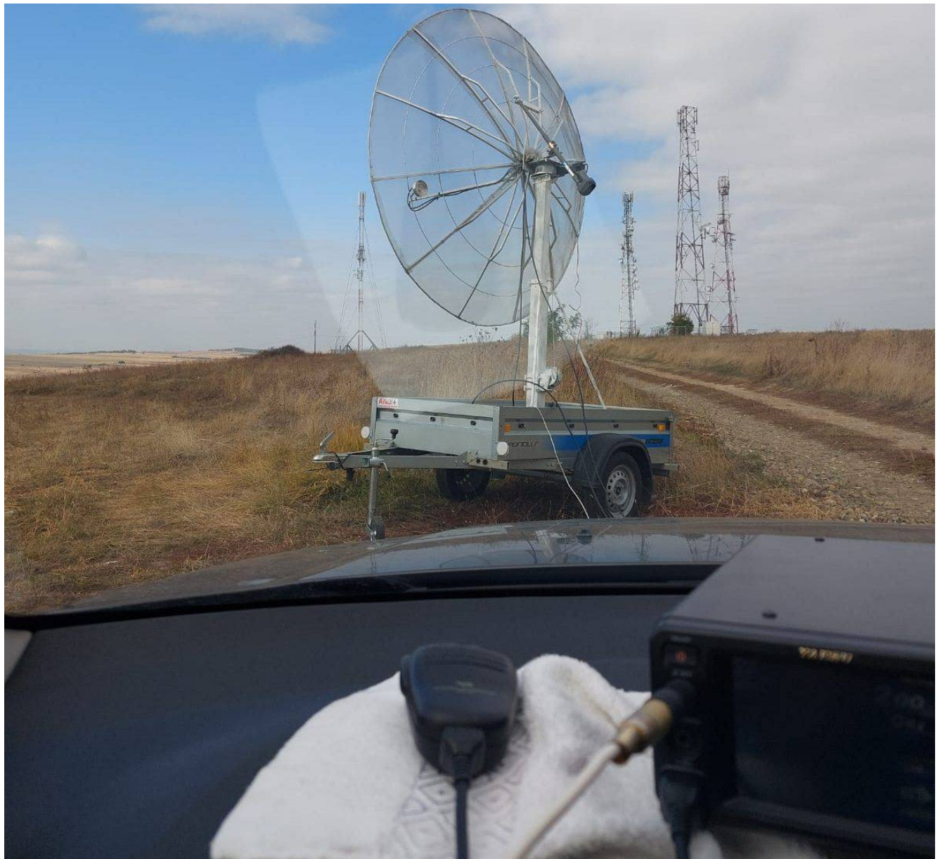
Auch das ist Portabelfunk, 250cm-Spiegel (Eigenbau) auf dem Anhänger – mni tnx to YO8RHM.
