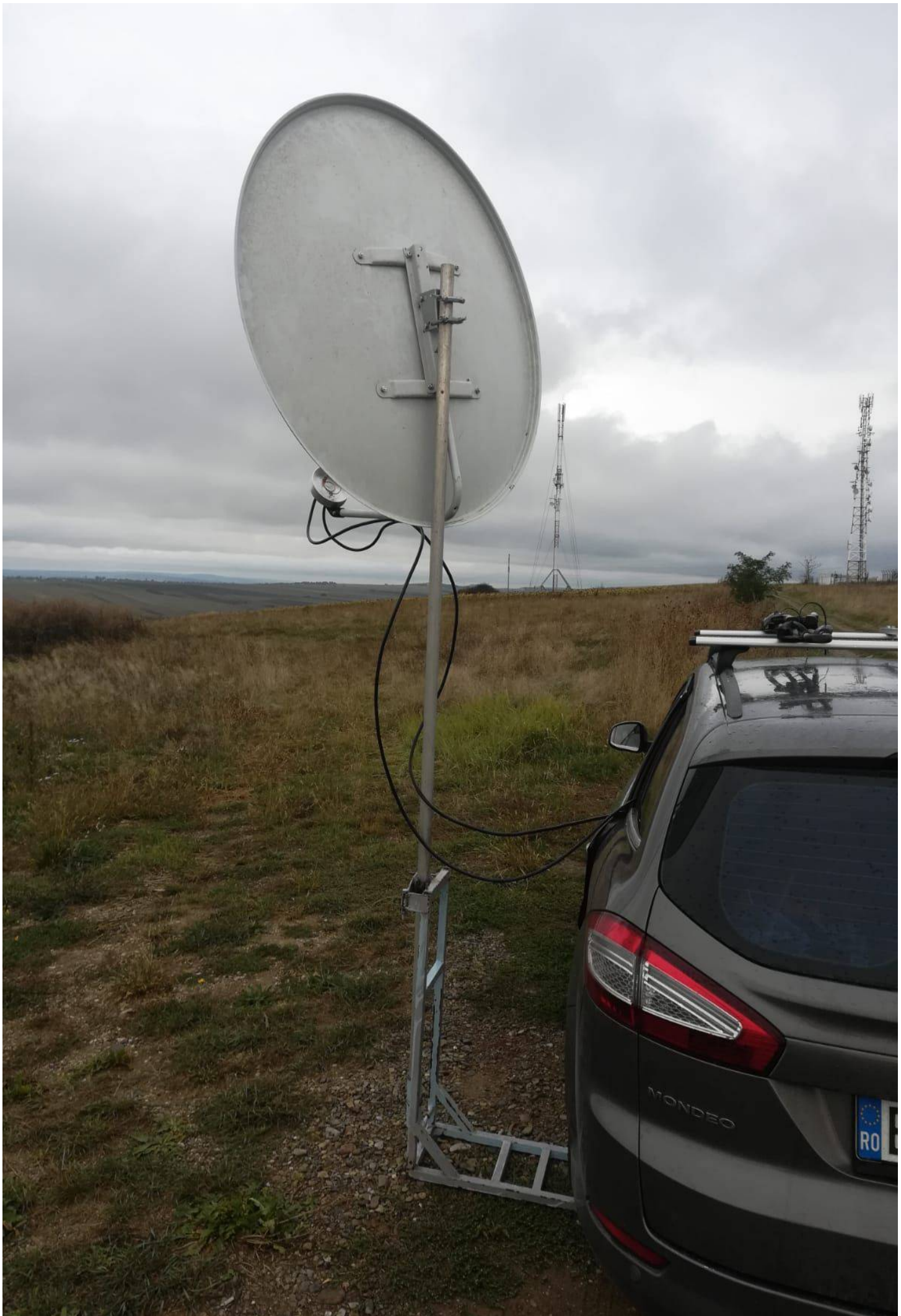
...das Ganze noch eine Version kleiner: 120cm-Vollspiegel am Rad-Ständer.
