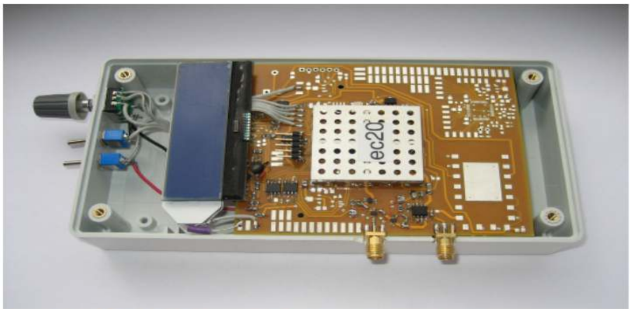
Das geöffnete Gerät: Die 99x80mm große Printplatte mit den SMD-Bauteilen. Die linke SMA-Buchse ist für die Antenne, die rechte für den 144.5 Mhz Empfänger.
