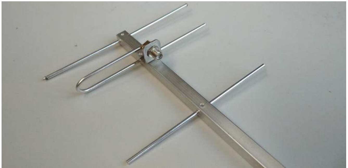
Hier sind die Elemente geschweißt mit WIG AlSi5, man kann sie aber auch mit Schrauben durch den Boom befestigen
