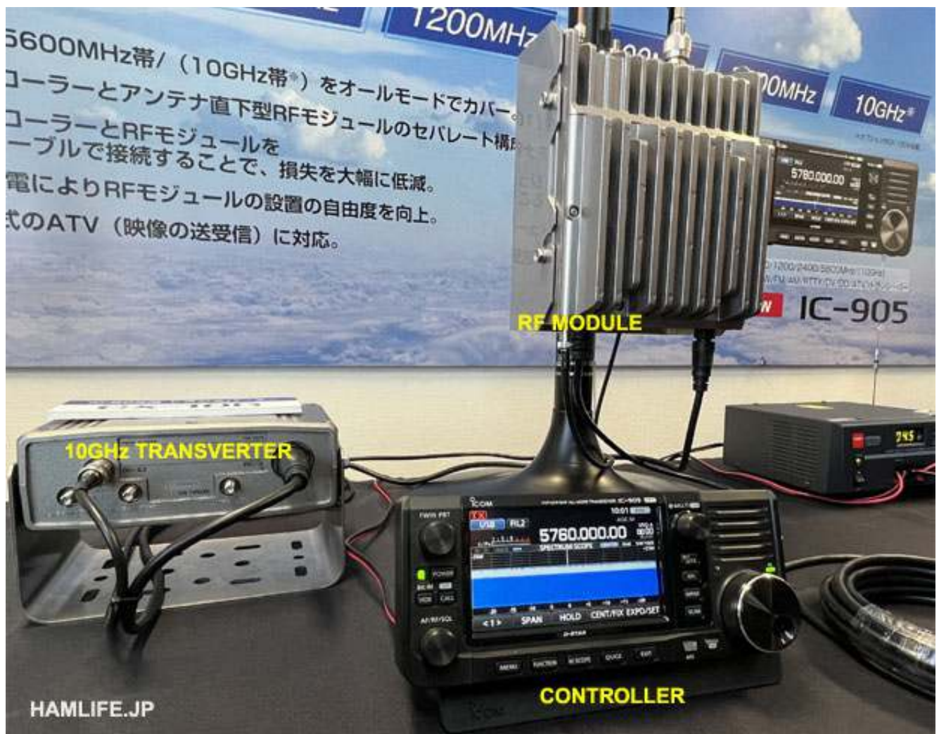
Der neue Ghz-Transceiver IC-905, geplanter Verkaufsstart: Frühjahr 2023, vermutlicher Preis: 3500-4000 $, der optionale 10GHz-Transverter wird mit ca. 1000$ in den Verkaufsstart gehen. (Quelle: ICOM Japan)
