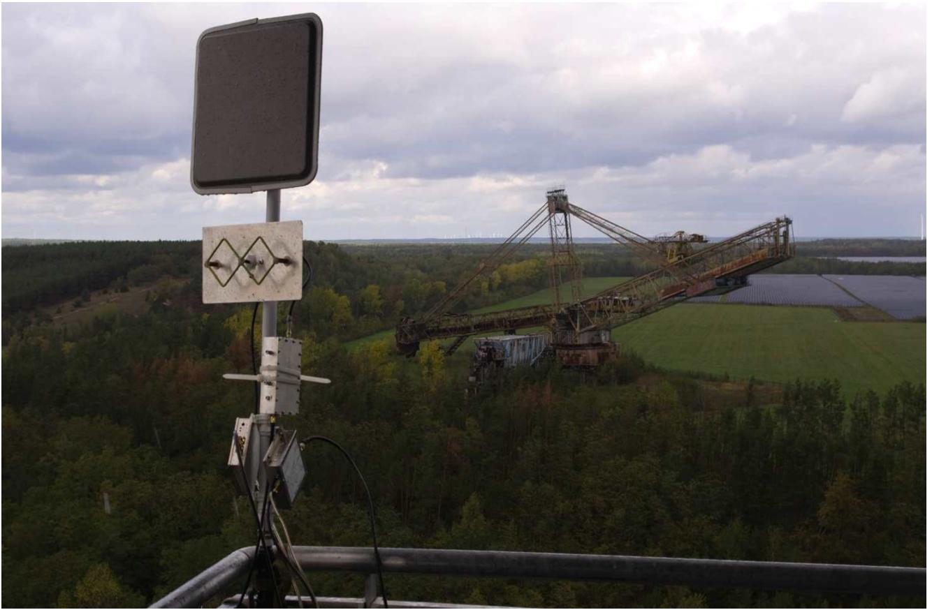
Alex` (DL2XF) - Station mit 23-cm-Interdigitalfilter und LZ5HP-PAs für 23 cm und 13 cm
