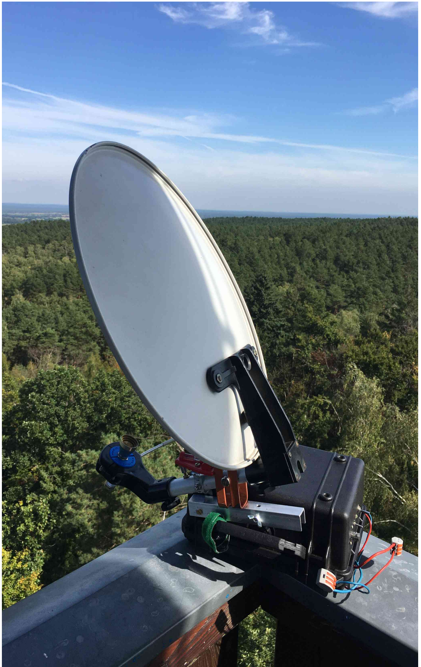
Jens, DL7VTX, auf 24GHz mit 2W und 35cm-Spiegel (ZF mit IC705), QTH: Wehlaberg 170m asl (Krausnicker Berge)
