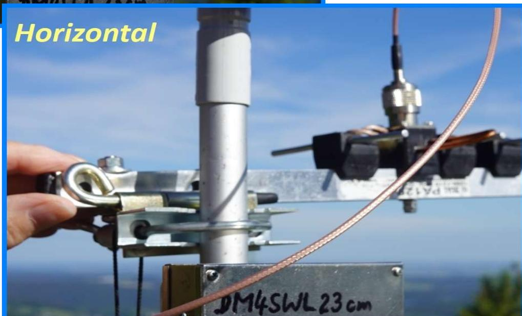
*Einfache Schwenkvorrichtung für Polarisationswechsel (SBW/DUR)*
