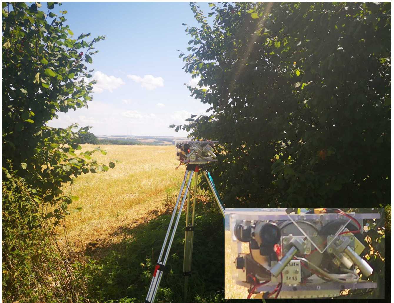
THz-Funk funktioniert besser im schattigen Bereich
