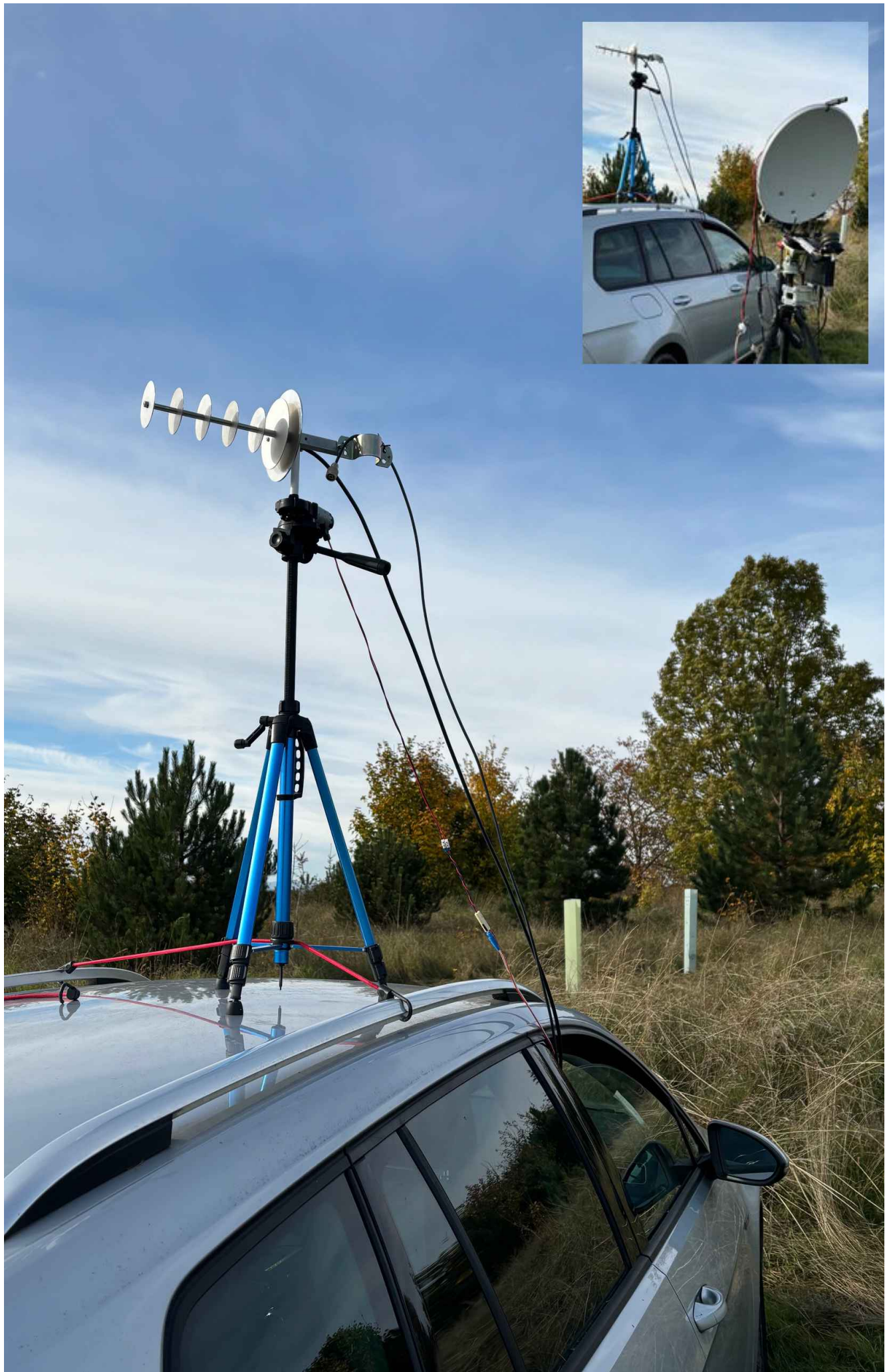
Siegmar, DG0AG: 23cm: Station 7 Element Scheibenantenne, 8W Sendeleistung, IC 9700. 3 cm Station: 35cm Offset-Spiegel, 4 W Sendeleistung auf 10368.1 MHz, Kuhne G3 Transverter, FT – 817 Standort JO50QV, Holzberg 459m, bei Blankenhain.
