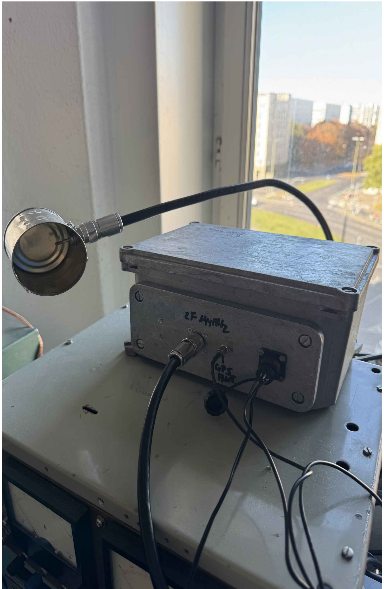
Micha, DG0VV: Meine neue 9cm Station: Kuhne Transverter mit neuer LO-PLL sowie 10Mhz Anbindung GPS synchronisiert und Endstufe 3.5 Watt. Den Dosenstrahler ( Kaffeesahnebüchse - abgeglichen) habe ich einfach aus dem Fenster gehalten um mit DC7QH ein QSO zu tätigen.
