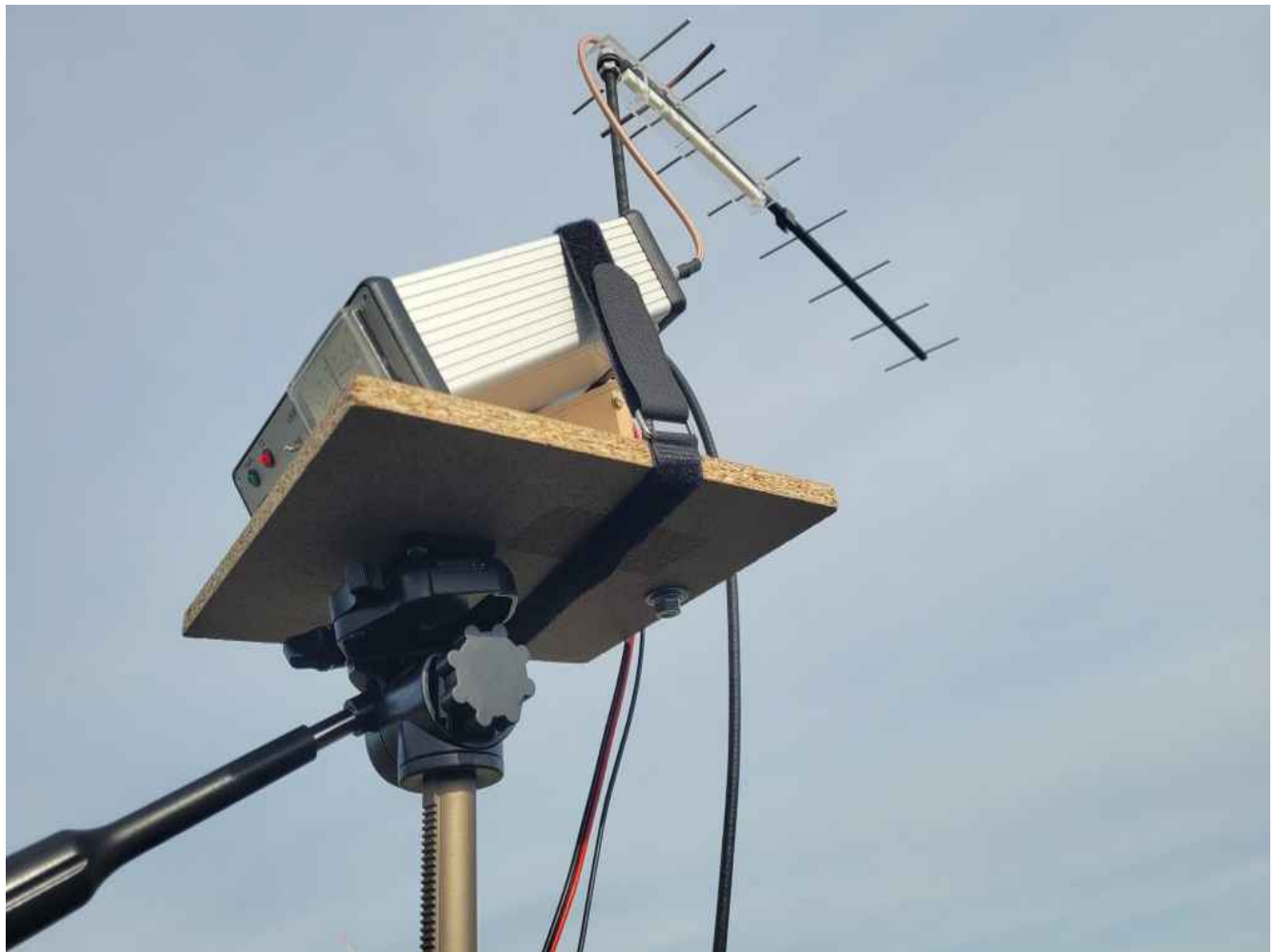
DK1RS' QRP-Station mit YBN 23-9m-Yagi und 2 Watt out.
