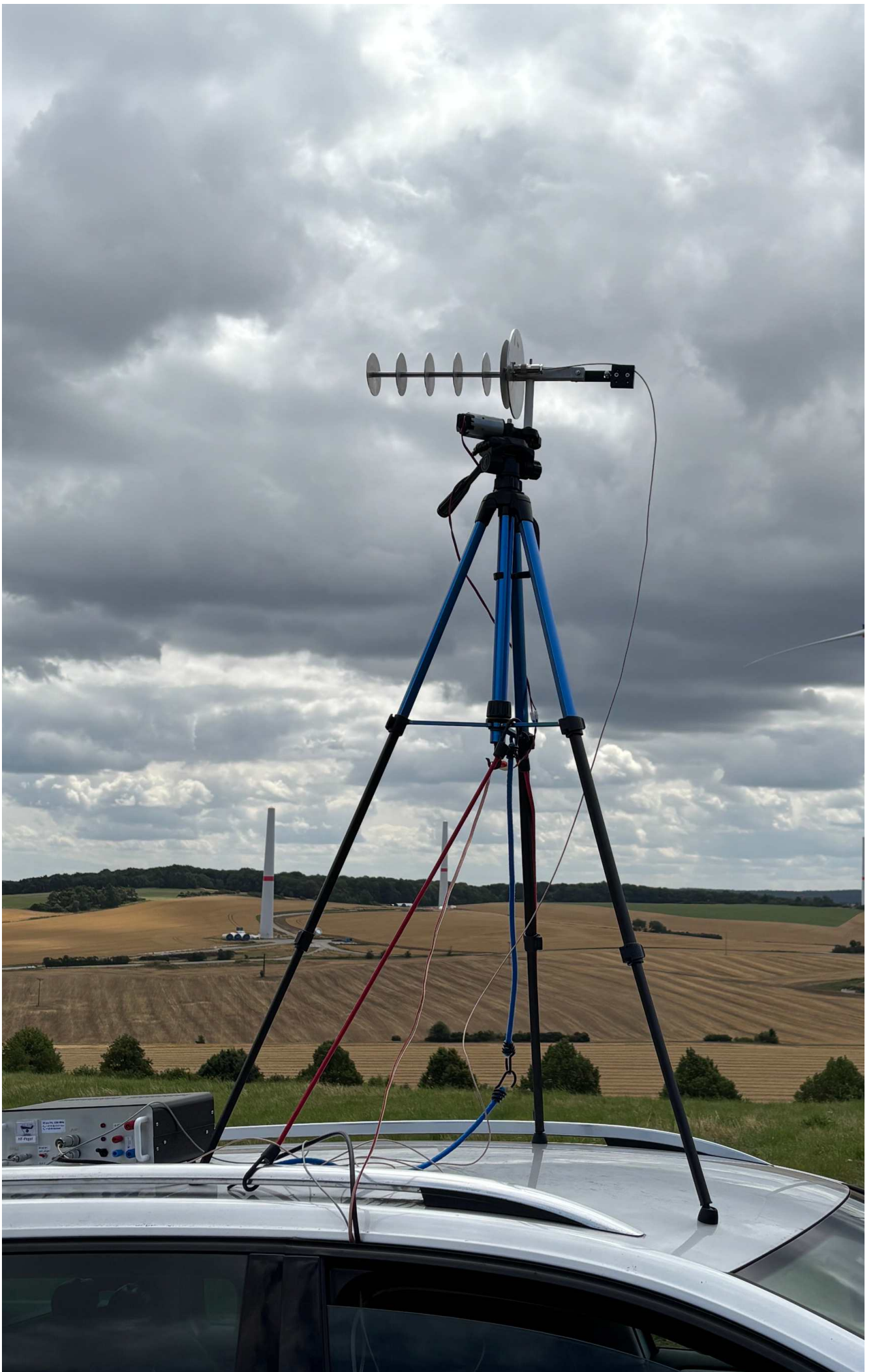
23cm-Scheibenantenne drehbar auf dem 4-Kreiser (tnx DG0AG).
